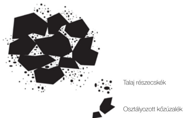
32. ábra: A mesterséges váztalaj (structural soil) sematikus ábrája
