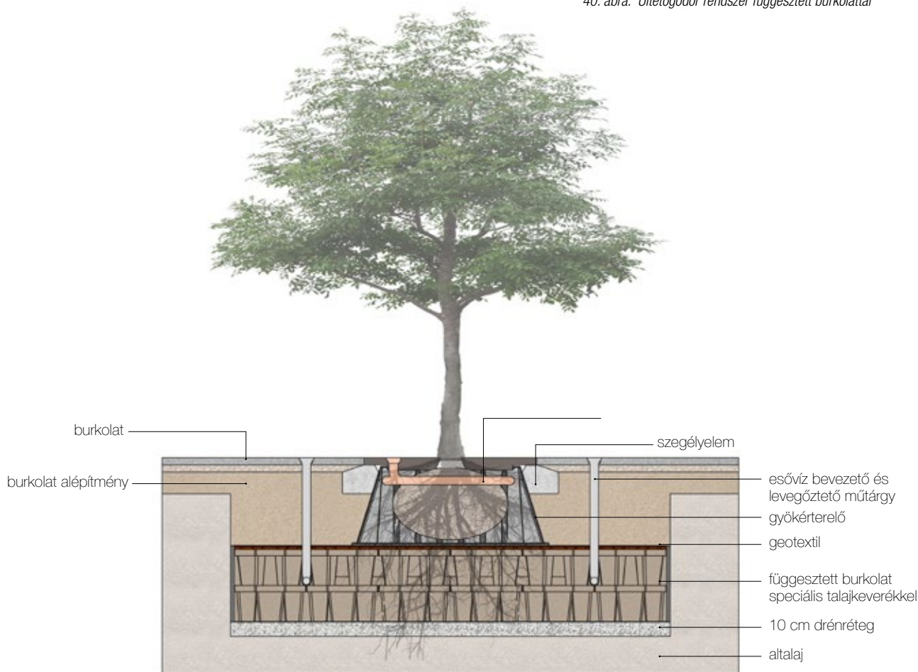
40. ábra: Ültetőgödör rendszer függesztett burkolattal
